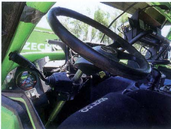
SPRÁVNĚ dimenzovaný a konstruovaný bezpečnostní rám udržel posádku při životě a nakonec i bez zranění.
